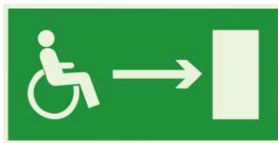
Znak AC012 Kierunek do wyjścia drogi ewakuacyjnej dla niepełnosprawnych w prawo
