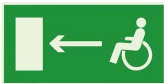
Znak AC013 Kierunek do wyjścia drogi ewakuacyjnej dla niepełnosprawnych w lewo
